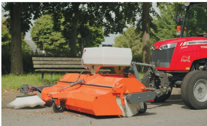
bema Kommunal 580 Dual mit Wassersprüheinrichtung für die Hauptkehrwalze und Seitenkehrbesen, Wassertank auf der Maschine
