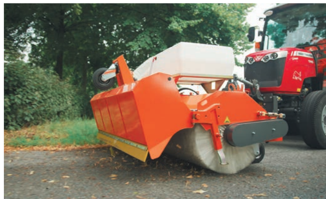
Schmutzsammelwanne im Dual-System - Blitzschnell zwischen Freikehren und Schmutz aufnehmen wechseln
